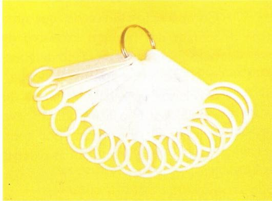
**Fig. 1.** Anelímetro para medição do diâmetro das bagas.
