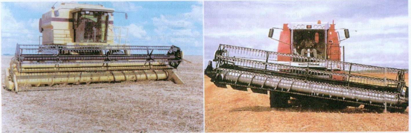
Figura 5 - Plataforma de corte flexível e com ajuste transversal
