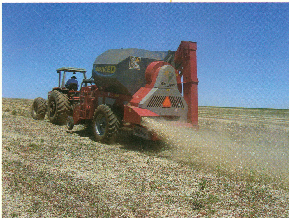
Recolhedora trilhadora de feijão com picador de palha que lança o material para trás, evitando cair na leira a ser recolhida
