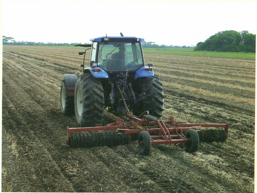
Modelo de destorroador que elimina irregularidades após o plantio
