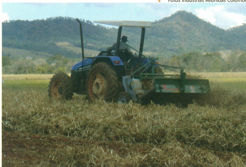
Virador de feijão em operação, importante no processo de aceleração e uniformização da secagem
