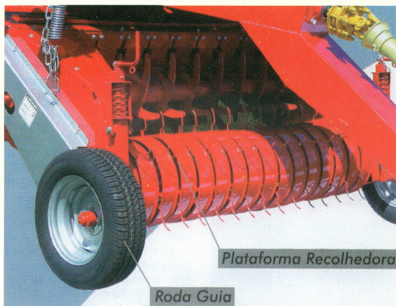
Figura 2 - Unidade recolhedora - as rodas guias mantém constante a altura de recolhimento
