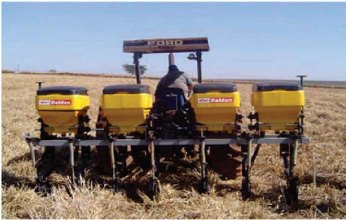
**Figura 11.** Equipamento para aplicação antecipada de N no sistema plantio direto.
