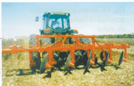
Fig. 12. Arrancador de discos da Watanabe acoplado ao hidráulico do trator.
