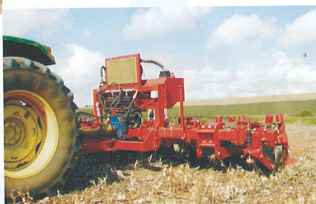
Fig. 17. Cortador de plantas de algodão em operação.
