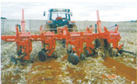
Fig. 10. JM Cotton Mil da Jumil acoplado à barra de tração do trator.
