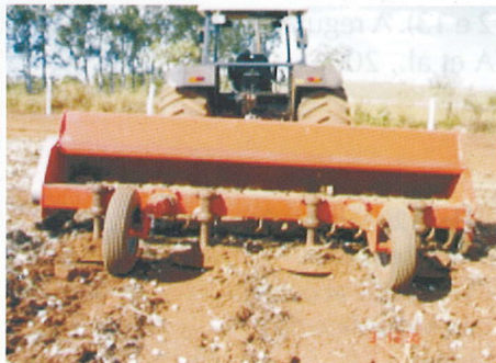
Fig. 14. Arrancador triturador acoplado à barra de tração do trator.
