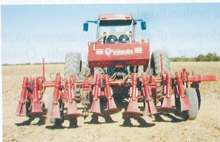
Fig. 16. Cortador de plantas, da Watanabe, acoplado à barra de tração do trator.
