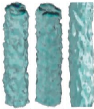
Figura 80 - Reconstrução 3-D de 3 seqüências de varreduras obtidas durante a infiltração da água na amostra PD2.
