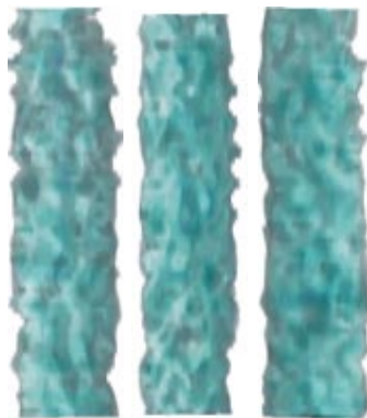
Figura 75 - Reconstrução 3-D de 3 seqüências de varreduras obtidas durante a infiltração da água na amostra PD1.
