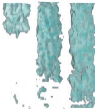
Figura 60 - Reconstrução 3-D de 3 seqüências de varreduras obtidas durante a infiltração da água na amostra PC3.
