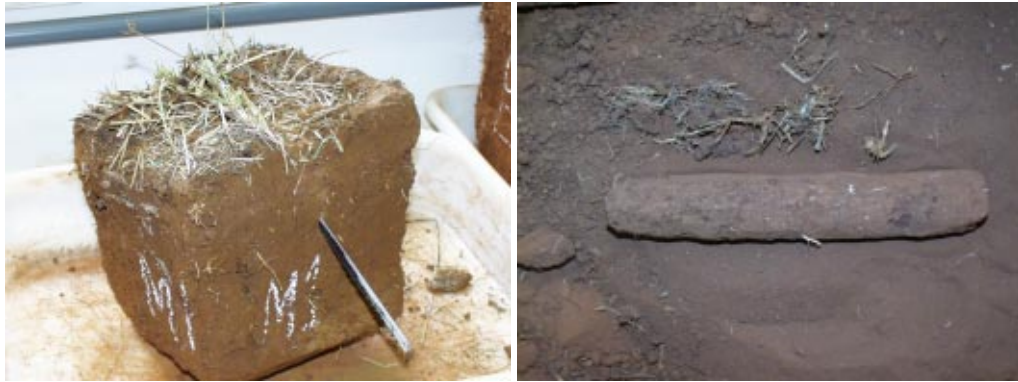
Figura 27 - Corte e raspagem do bloco de solo para retirada de amostra cilíndrica.
