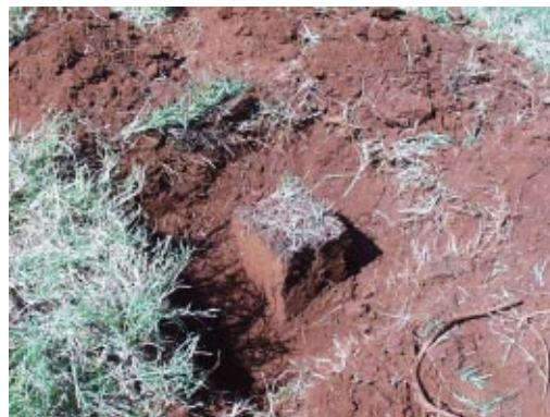
Figura 26 - Escavação para retirada de bloco de solo.
