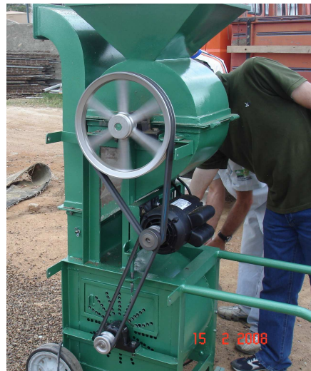
Figura 4. Detalhe do motor e disposição de polias e eixos.
