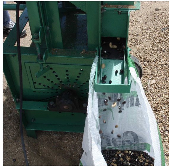
Figura 2. Saída das sementes após o descascamento.
