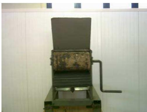
**FIGURA 1** – Máquina de descascar amendoim (Foto do autor)
