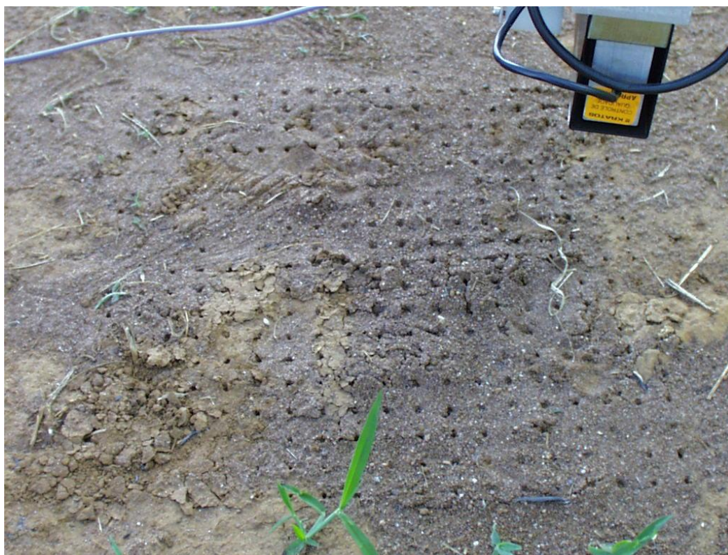
Figura 4.21 : Região de medida, após término da coleta de dados, onde se observa à área ensaiada com a microsonda.
