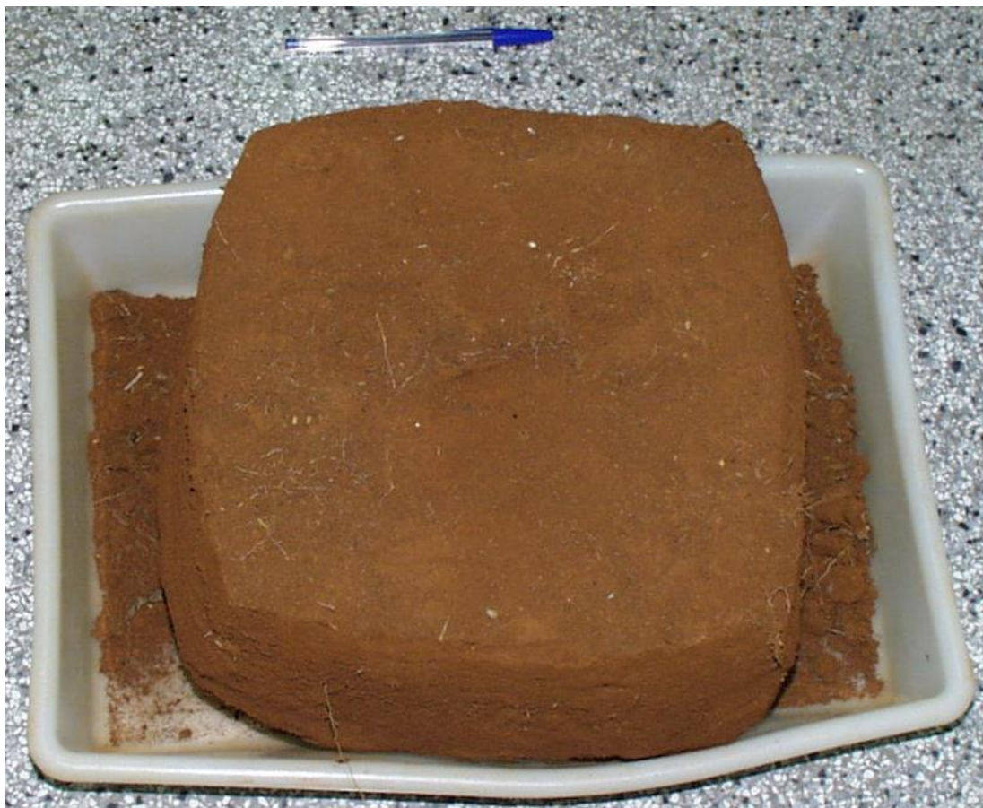
Figura 4.8 : Amostra de solo não deformado em forma de bloco, para o ensaio de geração de mapa de RSPRxPosiçãoxProfundidade (amostra coletada na Embrapa Pecuária Sudeste, com coordenadas geofísicas : latitude s21°57'10,9591", longitude o47°50'35,8174").
