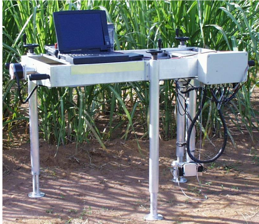
Figura 3.27 : Foto do instrumento para o mapeamento da resistência do solo à penetração de raízes.
