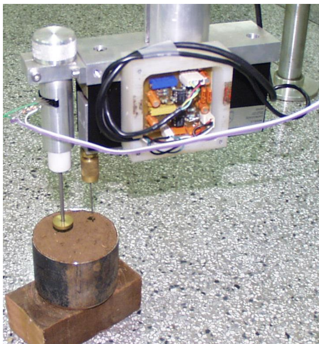
Figura 4.4 : Ensaio com uma amostra de solo (LVd2), coletado com cilindro amostrador.
