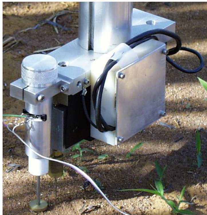
Figura 3.28 : Foto do conjunto de medida de força do instrumento para o mapeamento da resistência do solo à penetração de raízes.
