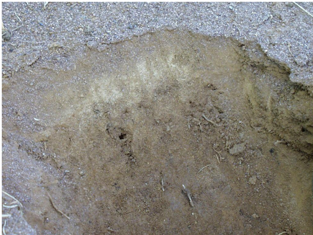
Figura 4.20 : Ilustração de um perfil do solo amostrado no ensaio de campo, onde se observa menor agregação próxima a região superficial.
