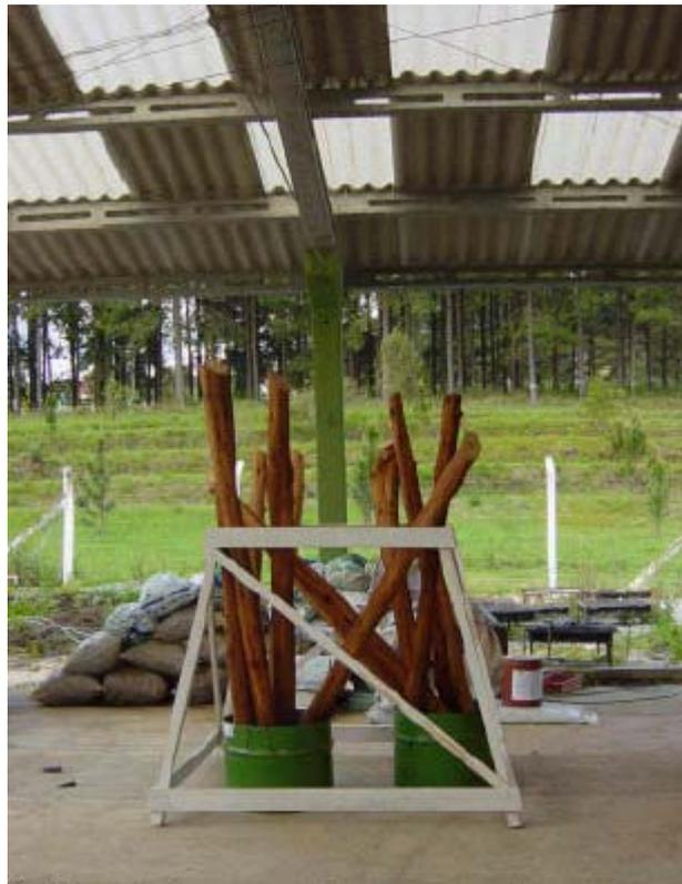
Figura 6 - Tratamento preservativo pelo método prático da substituição de seiva.
