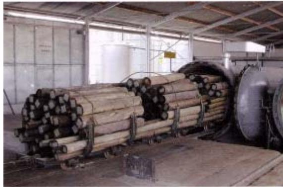
Figura 7 - Carregamento de autoclave para tratamento por pressão em usina de preservação de madeiras.
