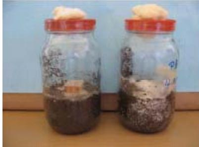
Figura 5 - Ensaio de biodegradação acelerada em laboratório.
