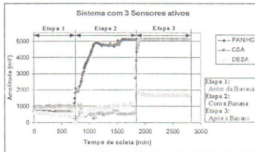
Figura 2 : Curva de resposta dos sensores
