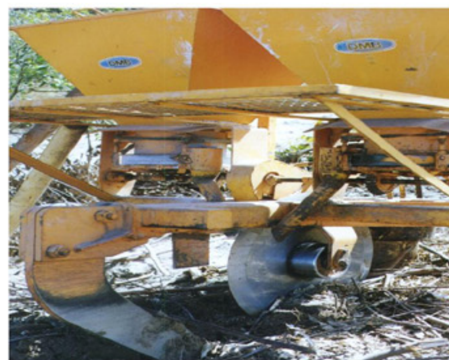
•Figura 2. Sulcador monohaste usado para revolvimento da entrelinha
