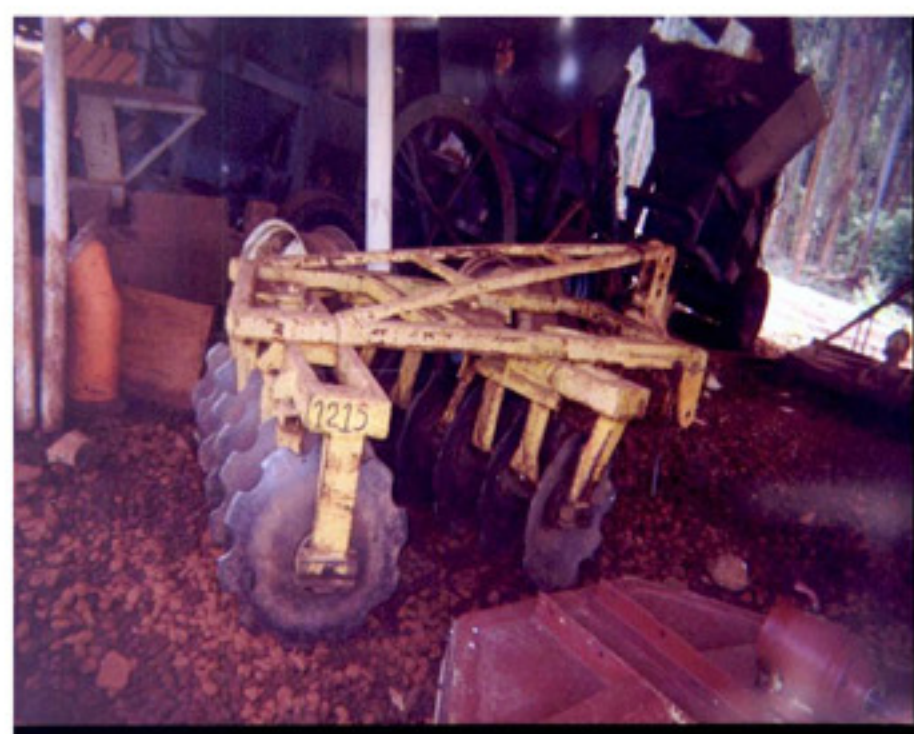
•Figura 1. Grade usada no para revolvimento da entrelinha
