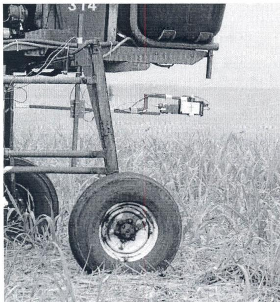
Figura 2 – Fixação dos sensores Crop Circle e Sonar.
