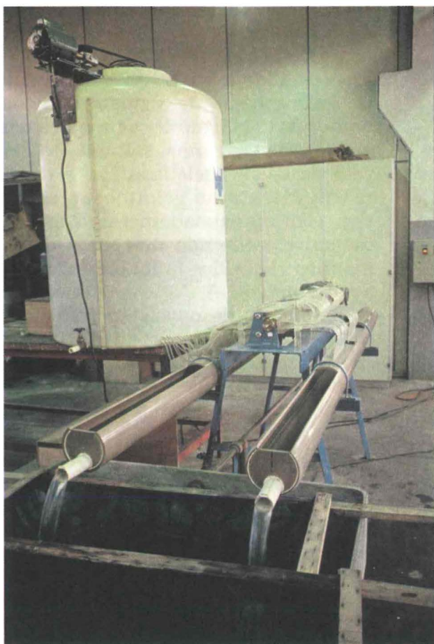
Figura 6. Detalhe do equipamento desenvolvido para a peletização de sementes de espécies pioneiras para semeadura aérea de áreas degradadas da Serra do Mar, Cubatão.
