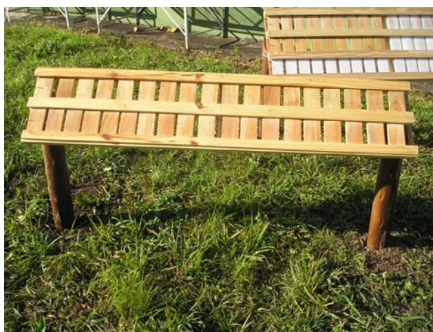
Figura 3 – Amostras de madeira de grevélea revestidas com diversos produtos nacionais expostas ao intemperismo natural na unidade da Embrapa Florestas em Colombo – PR.
