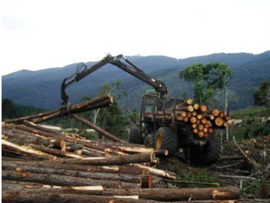
Figura 2. Tráfego intenso de autocarregável como causa da compactação do solo. Foto: Jarbas Y. Shimizu.
