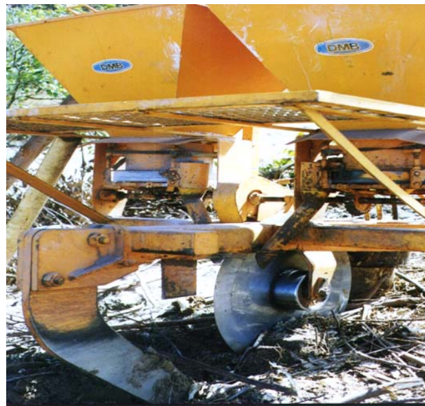
Figura 3. Sulcador monohaste usado para revolvimento da entrelinha. Foto: Sandra Cavichiollo.
