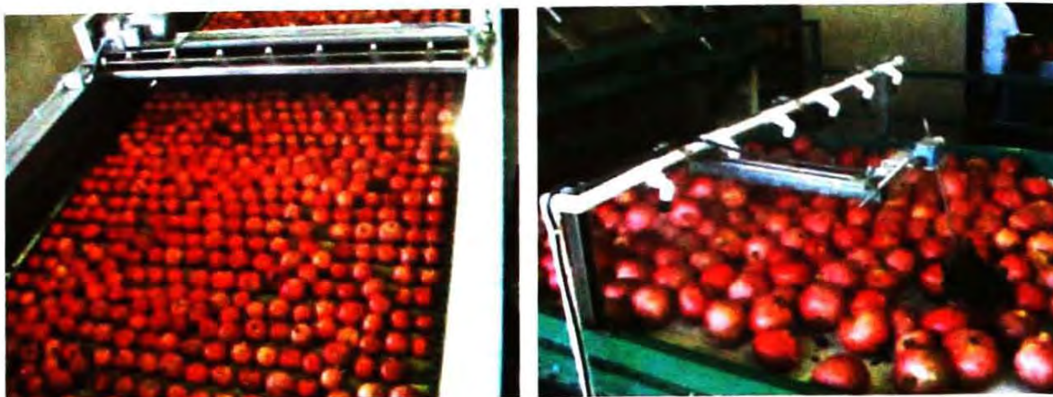
Fig. 1. Sistemas automatizados de recepção, lavagem e seleção de romãs (foto: Celso Luiz Moretti).
