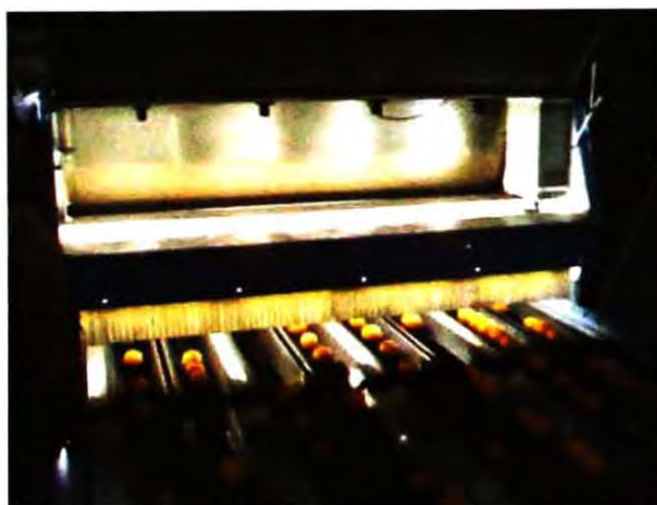
Fig. 2. Sistema óptico digital de seleção de frutos cítricos em casa de embalagem (foto: Celso Luiz Moretti).
