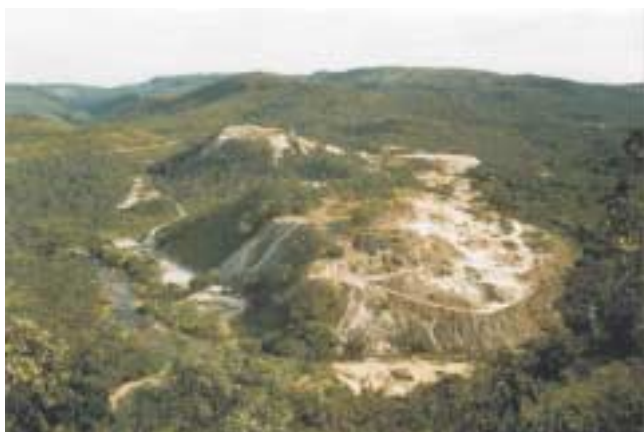
Foto 4.9 – Extração de quartzito para pedra-de-talhe. Note-se o desmatamento e o acúmulo de material de rejeito nas encostas do morro, o que está provocando o assoreamento da drenagem.
