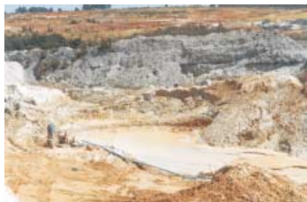
Foto 4.5 – Poços de bombeamento da areia extraída de quartzitos.
