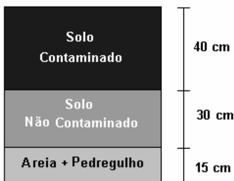
Figura 4.1: **Montagem dos Lisímetros**
