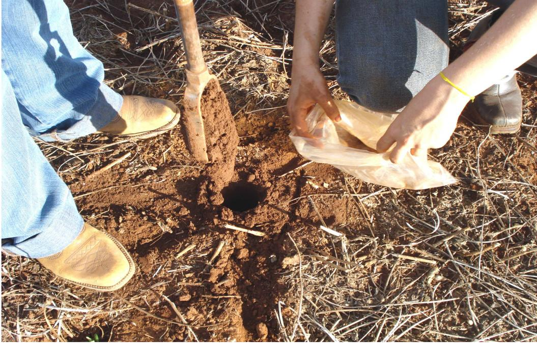
Figura 3. Amostragem de solo sendo realizada com o auxílio do trado holandês.
