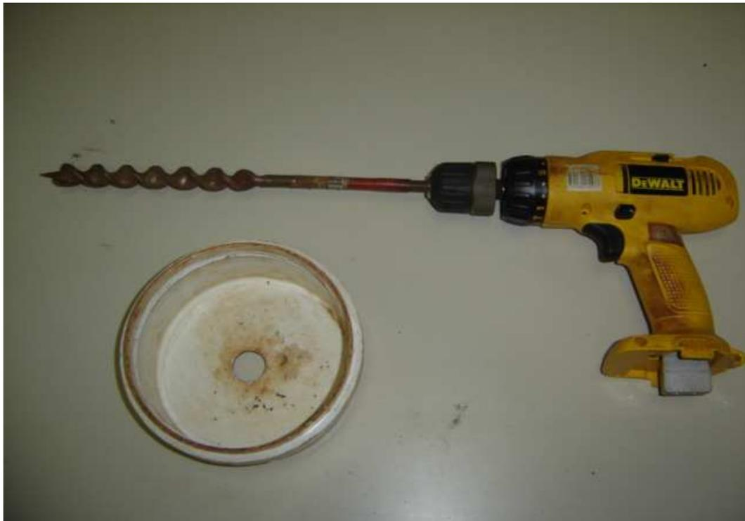
Figura 4. Furadeira elétrica e a base perfurada que é utilizada para coletar o solo.
