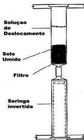
Figura 4. Esquema de montagem de coluna para extração de solução de solo (Wolt, 1994).
