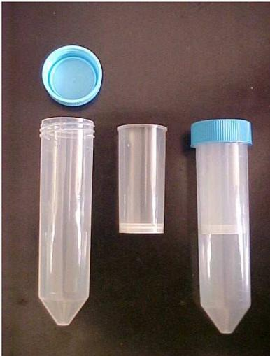
Figura 9. Tubo de centrífuga empregado na obtenção da solução do solo.
