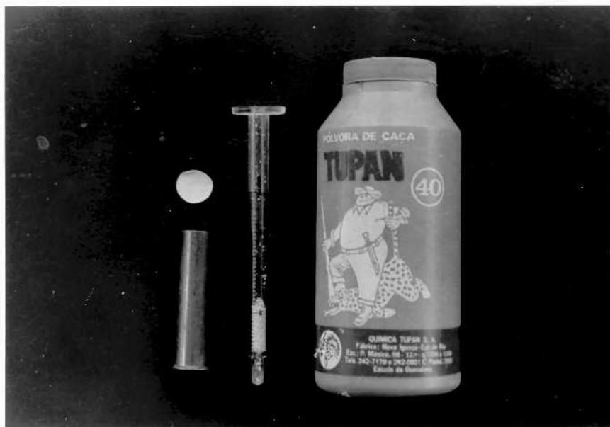
Fig. nº 3- A pólvora empregada, a seringa de insulina que mede as quantidades de pólvora a serem usadas, o cartucho de metal e a lâmina de papel que segura a pólvora no interior do cartucho
