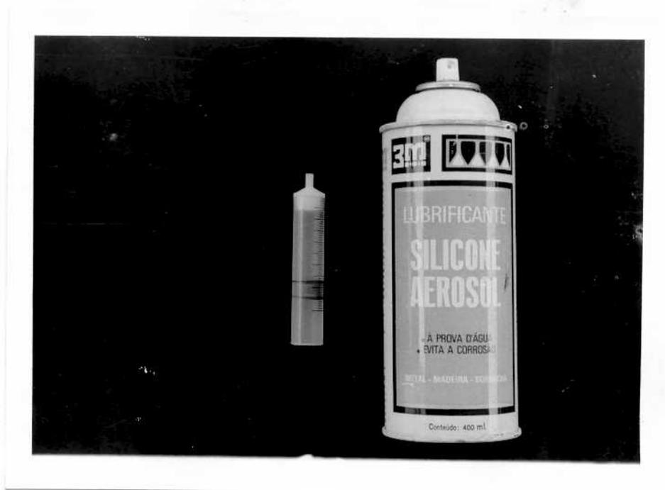
Fig. nº 5 - O corpo do dardo com o êmbolo no seu interior e o frasco de silicone empregado.
