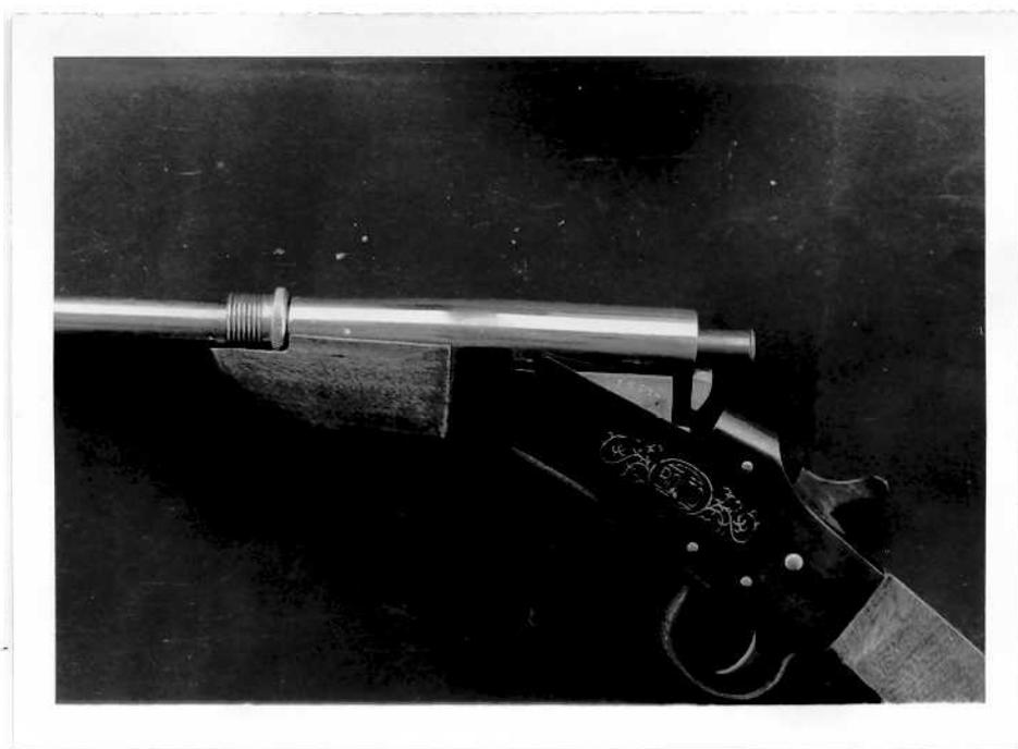
Fig. nº 21- Acoplamento do cano à arma, vendo-se o cartucho com a carga para o disparo.
