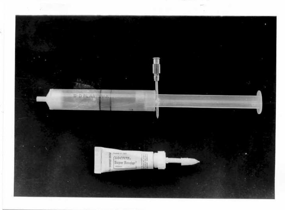
Fig. nº 6 - A cola para a rolha de borracha que irá formar a câmara de compressão do dardo, vendo-se o gabarito que limita a profundidade da rolha.
