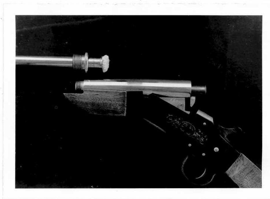
Fig. nº 20- Preparação da arma para o disparo, vendo-se o dardo no interior do cano, a redução rosqueada e o cartucho que lançará o dardo.
