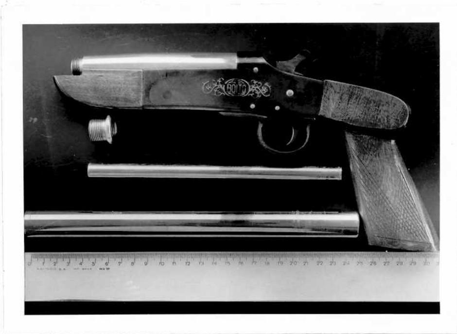
Fig. nº 1- A arma com os canos de 190mm x 11mm 250mm x 19mm e a redução rosqueada
