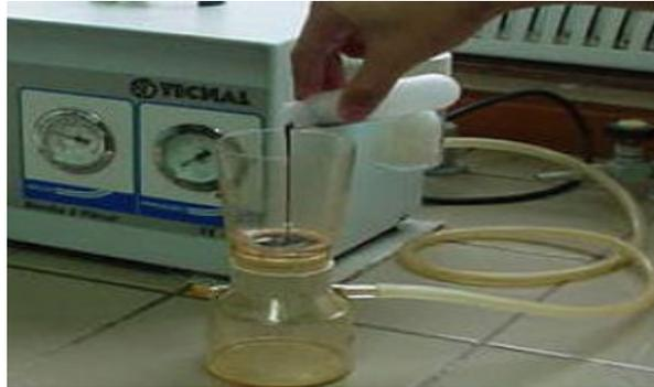
**Figura 39: Filtragem a vácuo do extrato acidificado para separação das frações ácido húmico e fúlvico. (Benites, 2003)**
