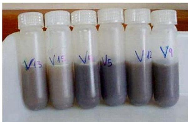
**Figura 35: Tubos de centrífuga de 50ml com solo e solução NaOH 0,1M em repouso após agitação manual. (Benites, 2003)**
