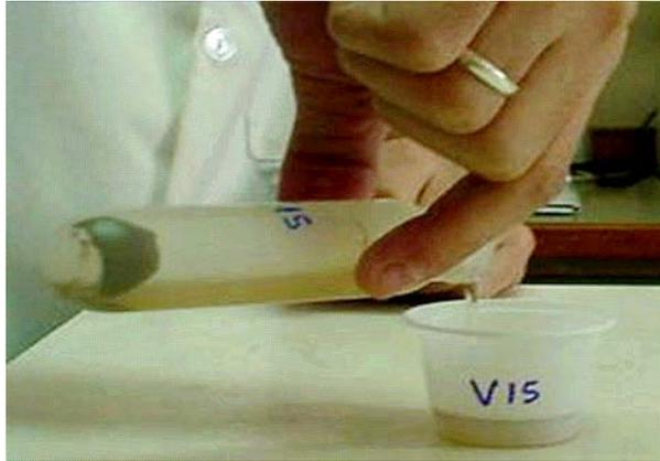
**Figura 37: transferência quantitativa do extrato alcalino do tubo de centrífuga para os copos plásticos. (Benites, 2003)**
