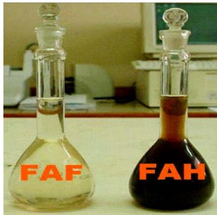
**Figura 40: Balões volumétricos de 50ml com as frações ácido fúlvico (FAF) e ácido húmico (FAH). (Benites, 2003)**
