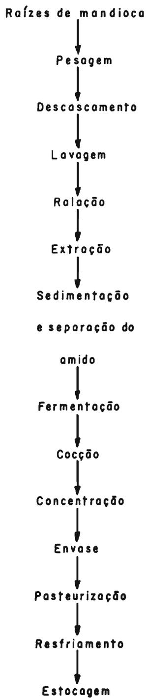
FIG. 6. Fluxograma para o processamento do tucupi concentrado.
