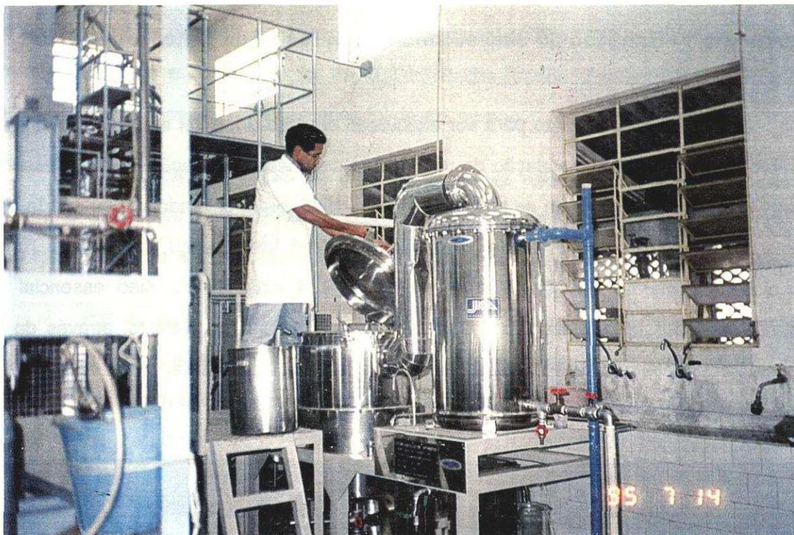
**FIG. 60 - Vista parcial da usina-piloto destacando-se o extrator de óleo essencial.**
