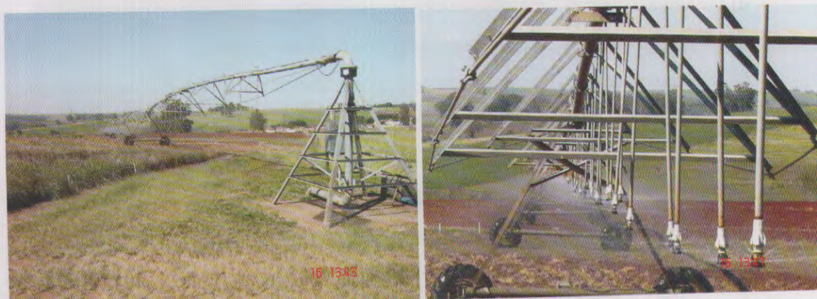
Fig. 7. Pivô central - ponto do pivô, torres e sprays ("aspersores"). Fotos: Fernando Campos Mendonça.
