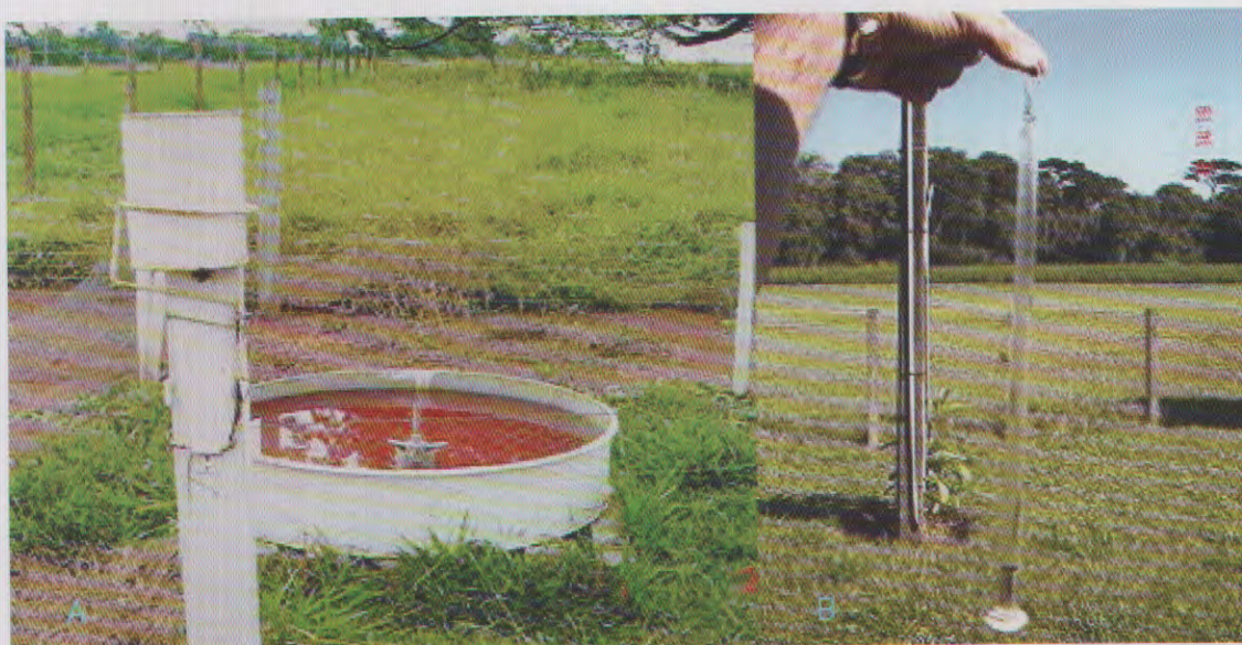
Fig. 3. (A) Tanque Classe A e pluviômetro, utilizados no manejo de irrigação (método EPS); (B) Evaporímetro de Piché, que pode ser utilizado em substituição ao tanque do tipo classe A.
