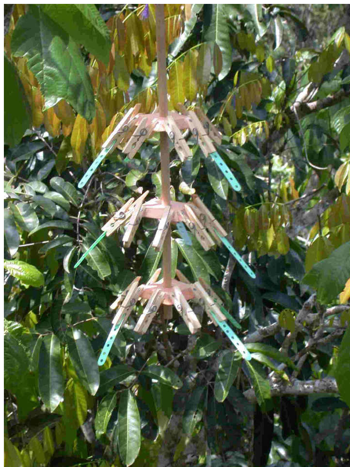
Figura 6. Armadilha para captura de pólen do tipo Megastigmata suspensa sob a copa de uma árvore feminina de Bagassa guianensis na Floresta Nacional do Tapajós, PA.
