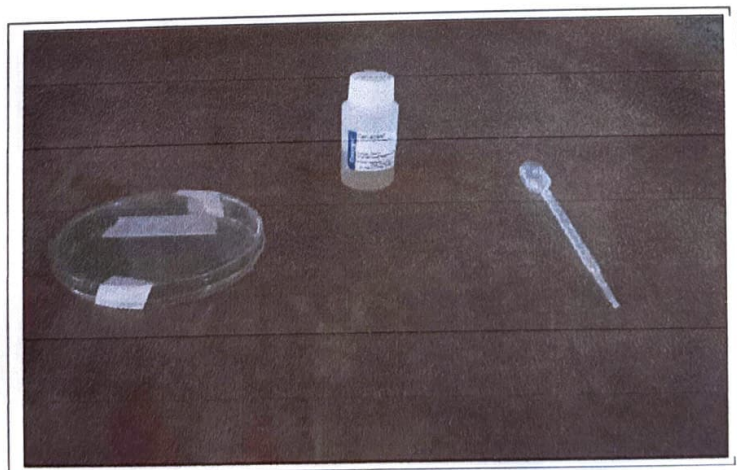
Figura 1: Kit bacteriológico contendo placa de Petri, meio-de-cultura e micro- pipeta.
