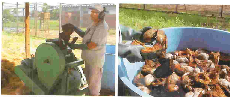
Figura 5. Triturador de casca de coco seco e imersão de casca em água para serem trituradas. Embrapa Tabuleiros Costeiros, 2005. Foto: Maria Urbana Corrêa Nunes
