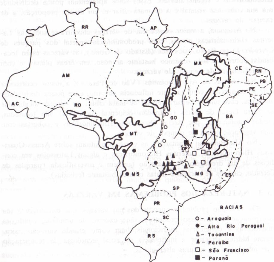
Fig. 13.1 Localização de perfis de solos de várzeas, amostrados nas principais bacias hidrográficas, na região dos Cerrados.
