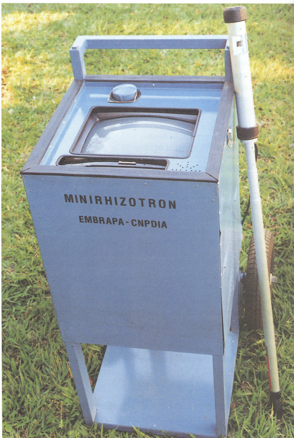
Figura 4 - Equipamento minirhizotron desenvolvido na EMBRAPA-CNPDI
