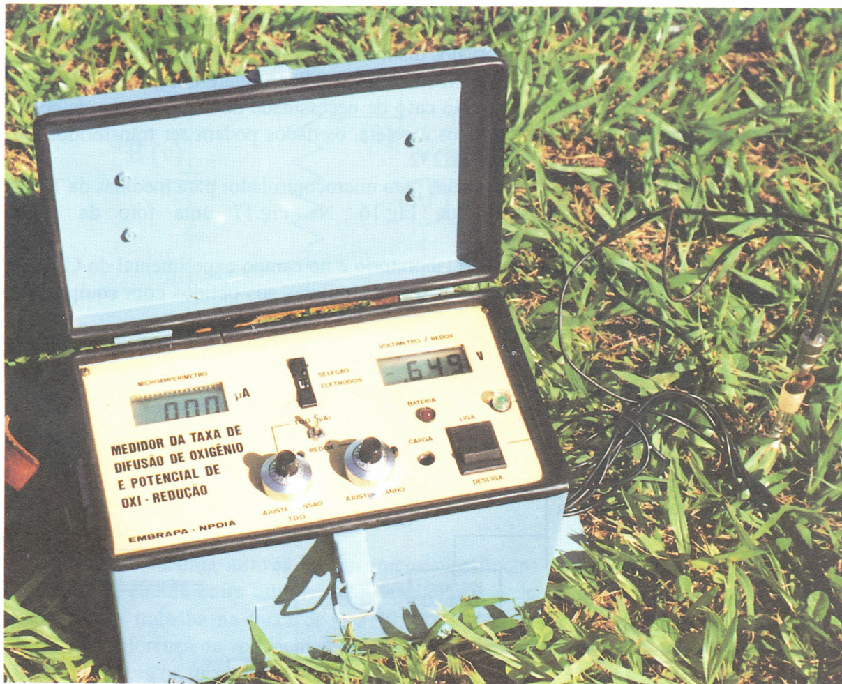
Figura 17 - Equipamento TDO - potencial REDOX na versão microcontrolada
