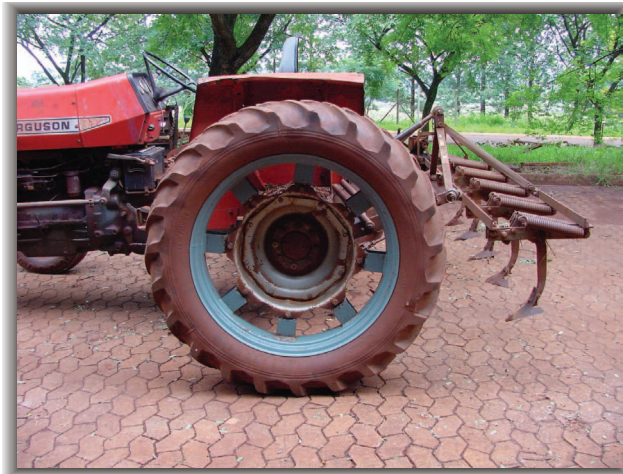
Fig. 3. Cultivador utilizado no controle mecânico de plantas daninhas em cultivos de girassol, no sistema de semeadura convencional.
