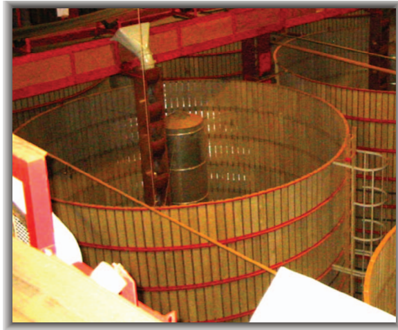
Fig. 11. Escada de semente para alimentação vertical de silos.
