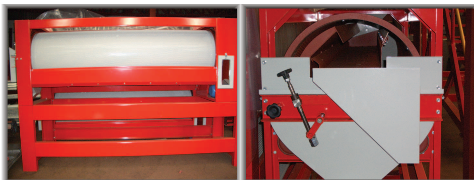
Fig. 7. Cilindro alveolado - Trieur. À esquerda, detalhe do cilindro, mostrando o sistema de ajustes. À direita, corte transversal do cilindro: A) parede do cilindro com seus alvéolos; B) calha ajustável para coleta da semente; C) borda da calha ajustável; D) rosca sem-fim na base do cilindro, que transporta o material rejeitado mais longo para fora do cilindro. A superfície interna cilindro é ilustrada à direita.
