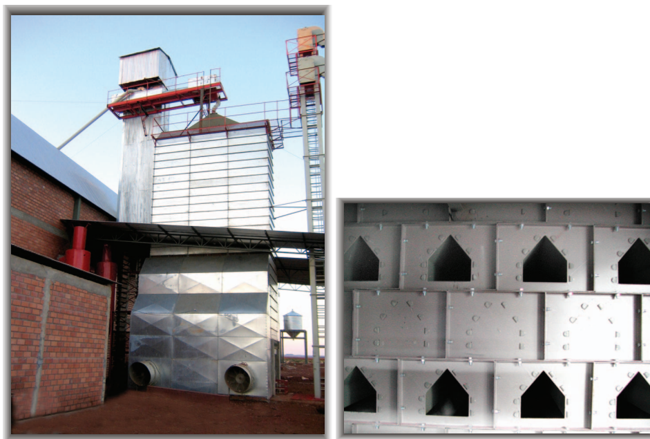
Fig. 4. Secador intermitente. À esquerda, foto do secador. À direita, foto de detalhe da torre de secagem.
