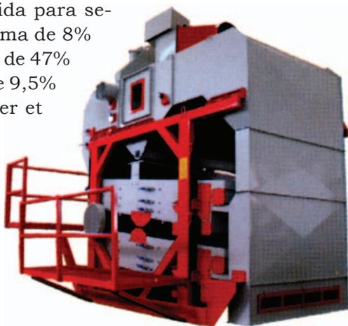
**Fig. 2.** Máquina de pré-limpeza.
