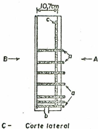
FIG. 1. Vista do modelo físico de laboratório. (a) tubos de drenos a 0, 3, 6, 12, 18, 24 e 30 cm do fundo; (b) tubos para permitir o esvaziamento da caixa; (c) poços de observação; (d) pontos de piezômetros; (d') detalhe de um piezômetro.
