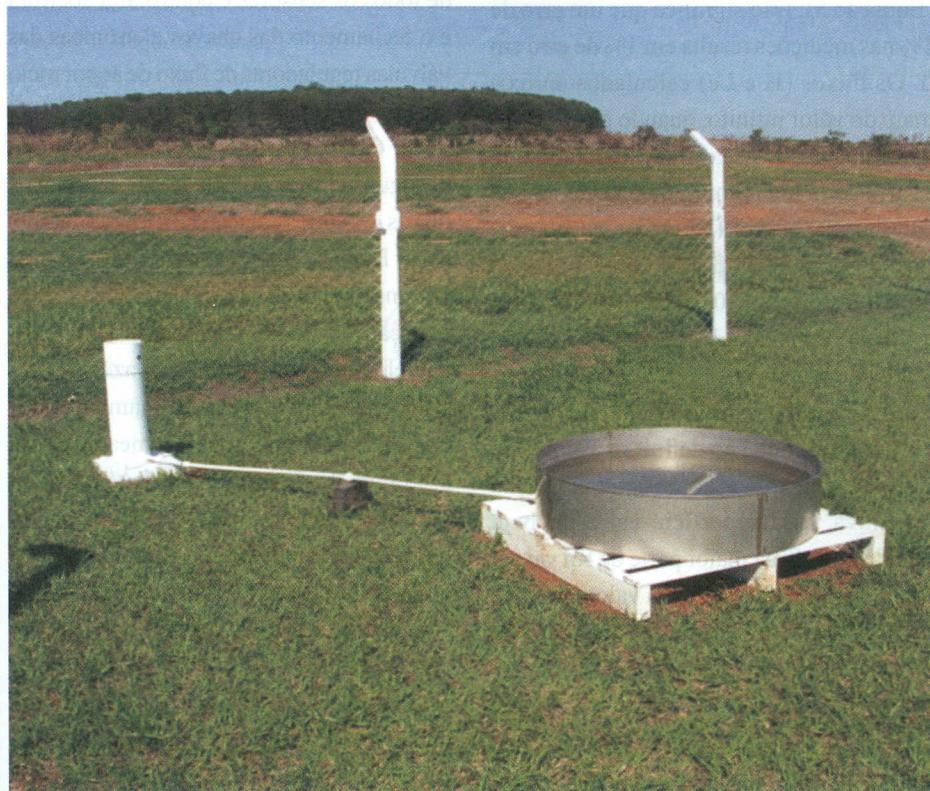
Figura 2 - Tanque Classe A para medição automática da evaporação da água
