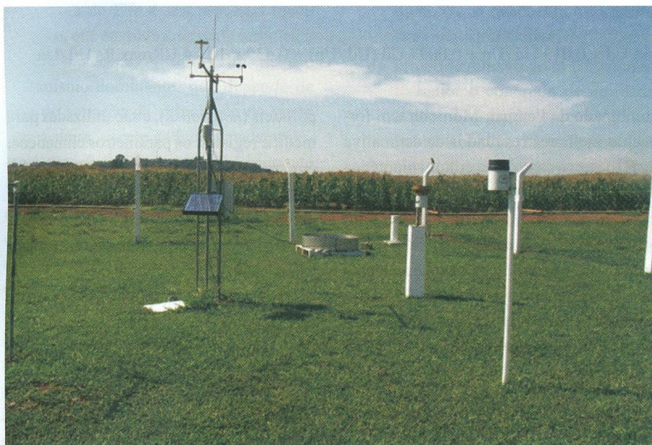
Figura 1 - Configuração típica de uma plataforma automática agrometeorológica com os sensores mais utilizados para fins de uso e manejo da água na irrigação
