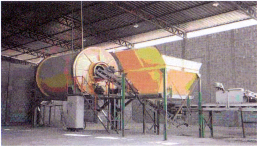
Figura 2. Moega de alimentação e misturador horizontal utilizado para a homogeneização da mistura antes da compostagem.
