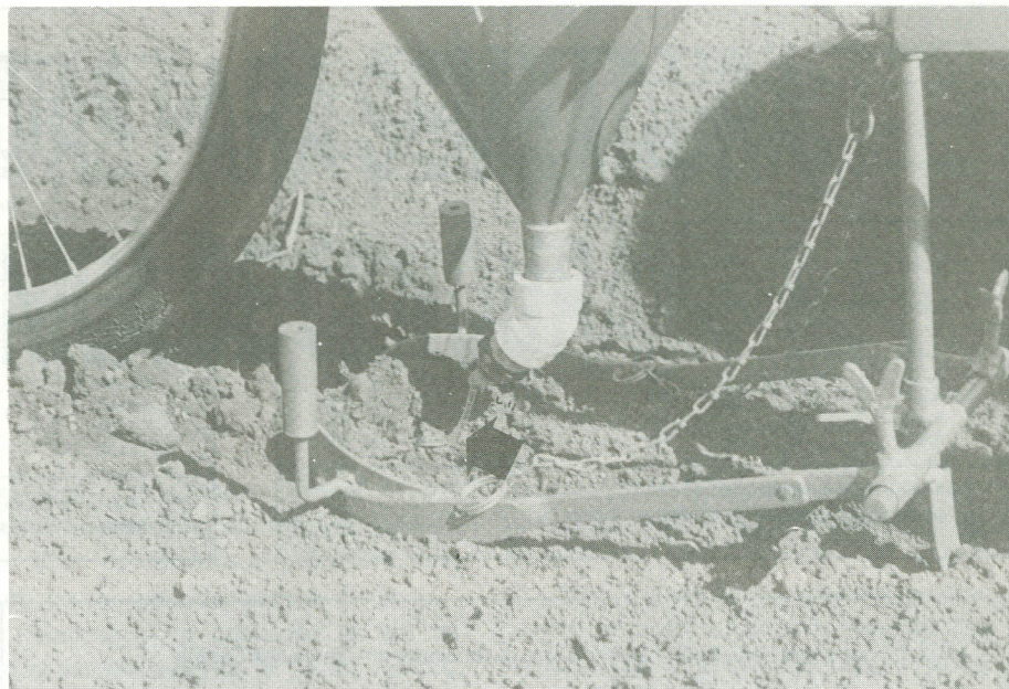
Fig. 3 – Distribuição da mistura de fluido-semente no solo, através do sistema de distribuição tipo êmbolo.
