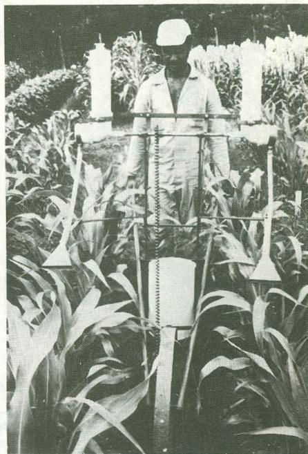
**Fig. 5 – Dispositivo para a aplicação de inseticida granulado diretamente no cartucho do milho**
