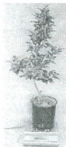
Figura 1. Sonda de calor transiente, controlada por computador, monitorando fluxo de seiva no caule de uma macieira e minilímetro de pesagem determinando transpiração da planta.
