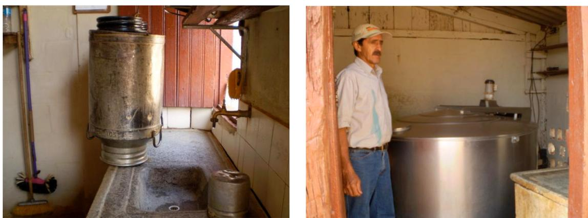
FOTO 8: uso do latão (tradicional) e o resfriador (moderno) para acondicionamento do leite.
