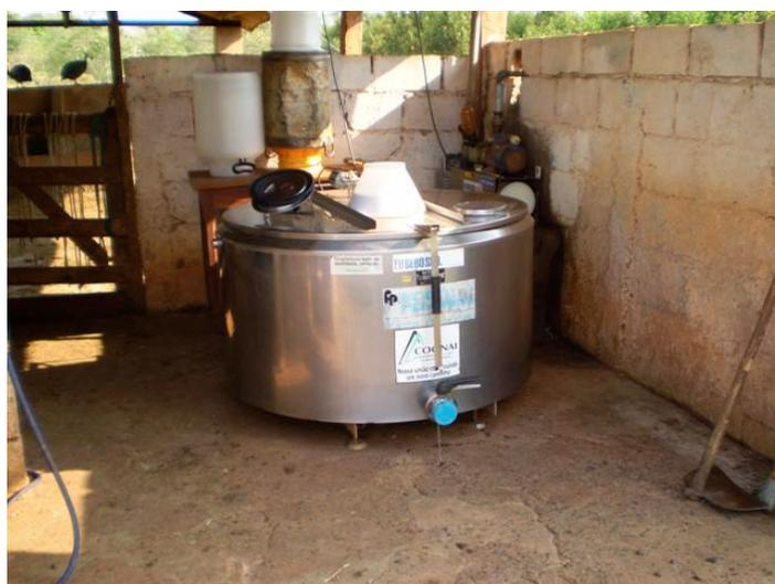
FOTO 2: tanque de expansão, instalado no espaço da propriedade, para acondicionamento do leite, até o momento da entrega ao caminhão da cooperativa.
