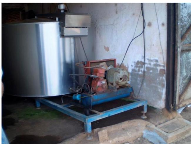
FOTO 7: motor antigo adaptado ao tanque de expansão - forma de reduzir custo, economia de dois mil reais (aproximadamente, dois mil e oitocentos litros de leite a preços da época).
