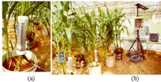
FIGURA 1. Sonda de balanço de energia (a) e sistema de medição automática de fluxo de seiva, instalado em segmentos de caules de plantas de milho (b) (Embrapa Milho e Sorgo, Sete Lagoas, MG, 2001).
