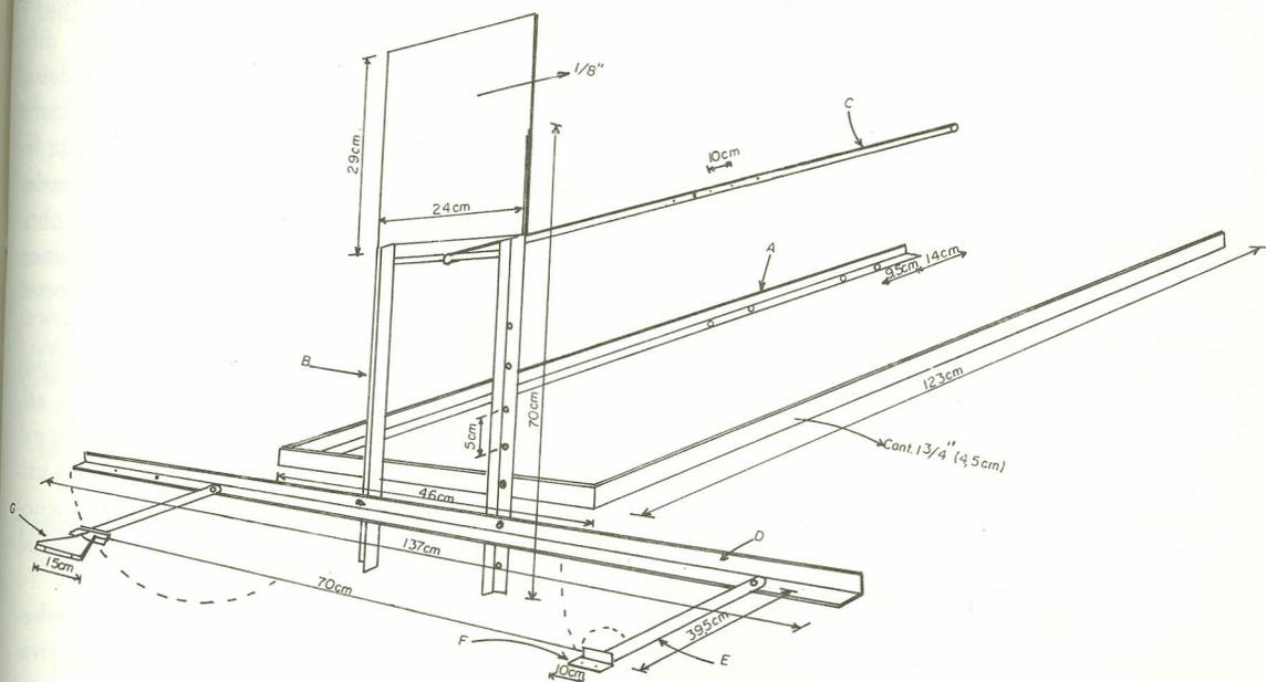
FIG. 1. Conjunto de adaptações necessárias para acoplar a granuladeira ao cultivador-adubador.
