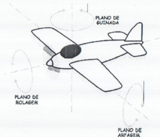
Figura 41. Principais planos de movimentação do avião (SOUZA, 1999).
