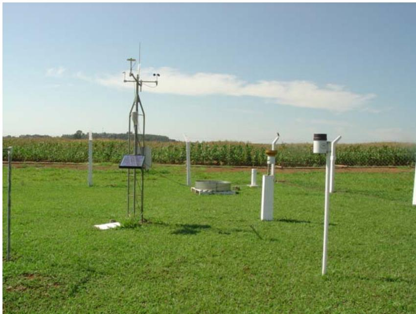
Figura 1. Estação climática automática do sítio-específico de precisão de Sete Lagoas, (Embrapa Milho e Sorgo, MG, 2005).
