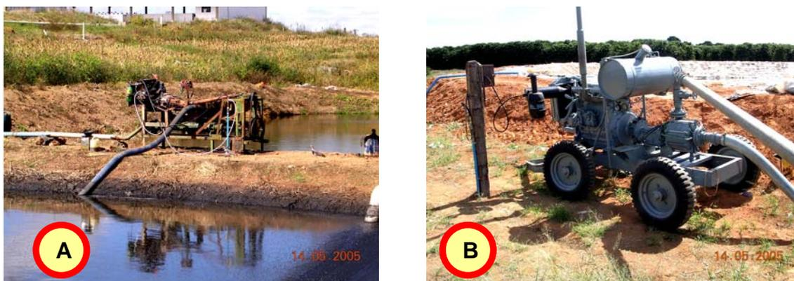
Figura 4. Transferência do biofertilizante com motor gasolina/biogás (A) e aplicação no campo via autopropelido com motor diesel/biogás (B).
