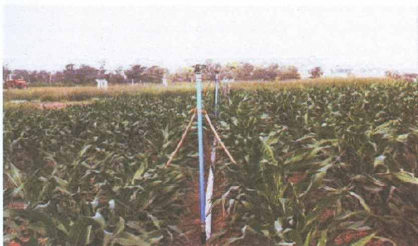
Figura 15.4 . Sistema de aspersão portátil com laterais móveis.
