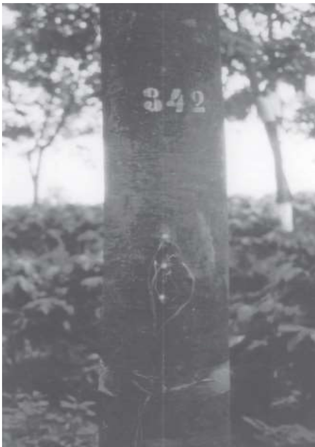
Figura 4. Visualização do sensor de fluxo de seiva do método da Sonda de Calor – Método de Granier de construção própria em seringueira do experimento.
