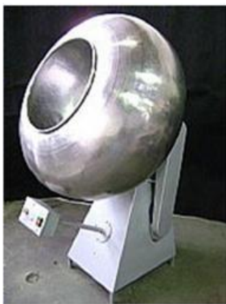
Figura 1. - Equipamento de encapsulação de sementes com regulador de velocidade (foto: José Maria Durán Altisent).
