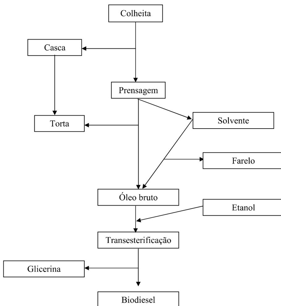
**Figura 1.** Processo de produção de biodiesel por transesterificação (Adaptado de Embrapa, 2006)
