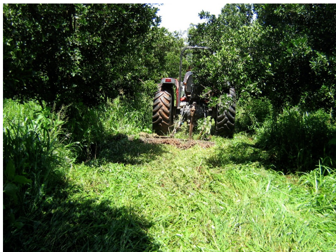
Figura 1. Manejo das plantas espontâneas na entre linha do pomar de citros, utilizando correntes acopladas ao trator para 'deitar o mato' sobre o solo (Foto: Raimundo Nonato, Dezembro, 2005).
